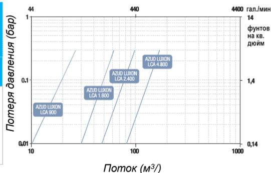
Характеристики потока в зависимости от условий фильтра, частота активации процедуры промывки. Данные для фильтров до 125 микрон и воды хорошего качества.
