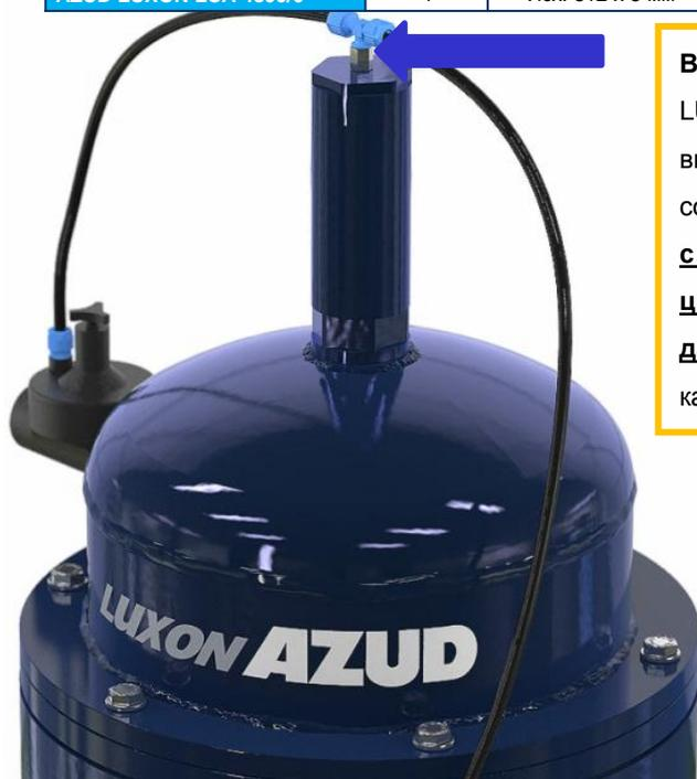
**ВАЖНО:** В случае если оборудование AZUD LUXON LCA используется в условиях давления выше 7 бар, разберите гидравлическое соединение реле, **выкрутите и извлеките втулку с маркировкой «Низкое давление» (синий цвет), замените ее на втулку «Высокое давление» (черный цвет)**, поставляемую в качестве запасного элемента.
