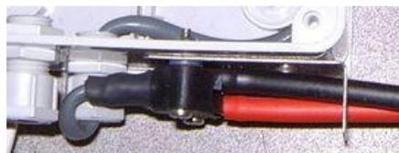
Пользователю важно установить небольшой фильтр с сеткой 120-130 микрон между красной трубкой и точкой высокого давления. Производитель устанавливает сетку в оборудовании AZUD LUXON LFH.
